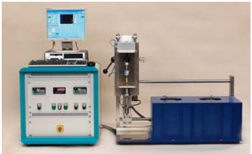
Gieseler-Plastometer mit zwei Öfen und einem Testkopf der Prüfer GmbH mit integrierter Delphin-Messtechnik
