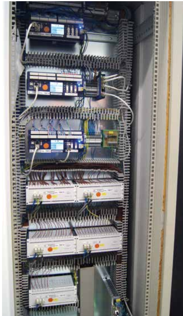
02 Insgesamt werden an der Digitaldruckmaschine 189 Signale mit den drei Expert-Loggern sowie den fünf Profi-Message-Geräten aufgezeichnet und visualisiert
