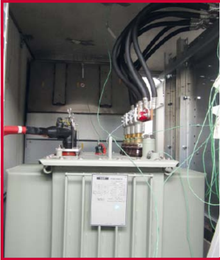
Im Prüffeld wird die Wärmeentwicklung in Kompaktstationen mit Thermoelementen und PT100-Sensoren erfasst. Befestigt sind sie unter anderem am Transformator (linkes Bild) und der Niederspannungsseite (rechtes Bild).
