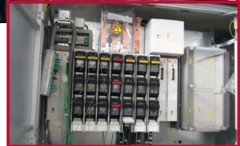
Im Prüffeld wird die Wärmeentwicklung in Kompaktstationen mit Thermoelementen und PT100-Sensoren erfasst. Befestigt sind sie unter anderem am Transformator (linkes Bild) und der Niederspannungsseite (rechtes Bild).
