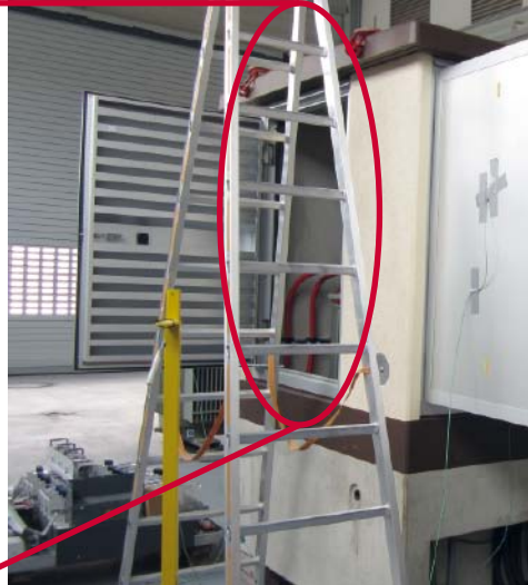
Im Prüffeld wird die Wärmeentwicklung in Kompaktstationen mit Thermoelementen und PT100-Sensoren erfasst. Befestigt sind sie unter anderem am Transformator (linkes Bild) und der Niederspannungsseite (rechtes Bild).
