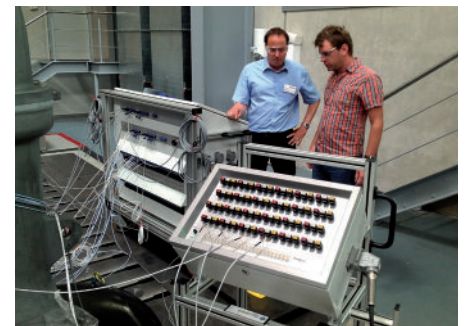
03 Clemens Kraus (re.) erklärt Chefredakteur Dirk Schaar die Anlage – im Vordergrund sieht man den Temperatursatelliten
