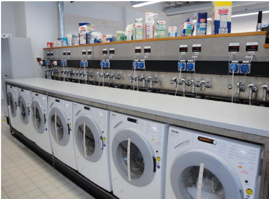
Eine Seite der Waschmaschinen-Brücke, wie sie zum Testen von Waschmitteln eingesetzt wird.
