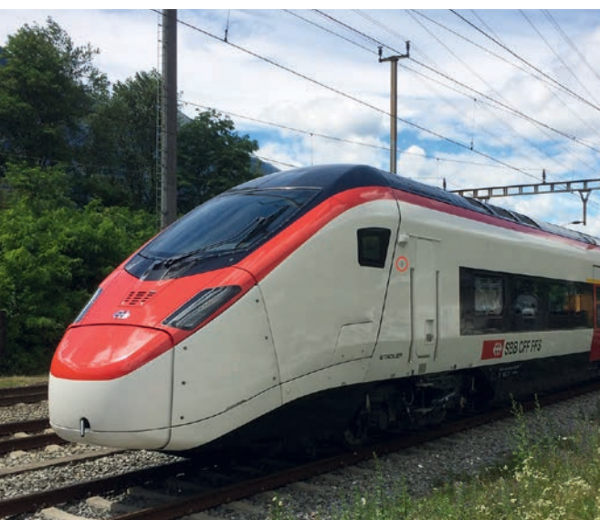
Die Sensoren für den Außendruck sitzen im Inneren des Zuges und sind über einen Pneumatikschlauch an eine Öffnung (roter Kreis) in der Zugaussenwand angeschlossen.
