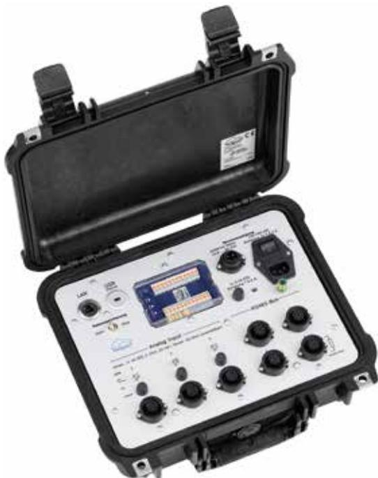
**02** Handlich und kompakt – die Größe der Messkoffer richtet sich nach der benötigten Kanalzahl und der enthaltenen Messtechnik. Hier ein besonders kompakter Messkoffer mit einem Loggito-Datenlogger
