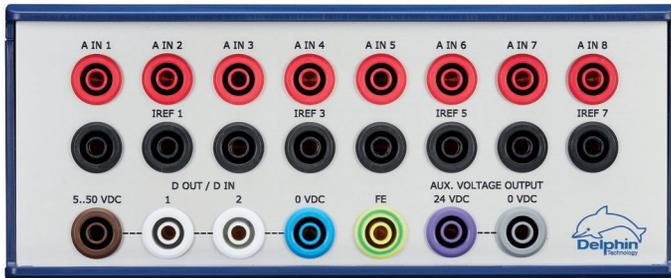
**01** Anschlussvariante: 8 AI-RTD mit acht Analog-Eingängen für den Anschluss beliebiger Spannungs-, Strom- und RTD-Signale in Zwei-, Drei- und Vier-Leitertechnik über 4-mm-Laborbuchsen
