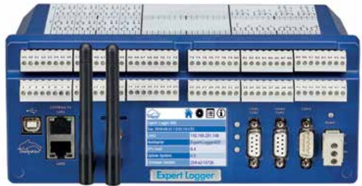
Delphin hat den Kommunikationsstandard OPC UA erstmals in dem kombinierten Datenlogger und Automatisierungsgerät Expert Logger 400 integriert.
