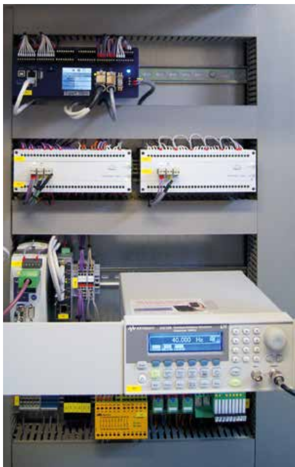
05 Die Expert-Vibro-Geräte sind speziell für den Einsatz als modulare Mess-, Steuer- und Überwachungsgeräte entwickelt worden. Über ein Master-/Slave-Gerätekonzzept und verschiedene IO-Module werden sie an die jeweilige Anwendung angepasst
