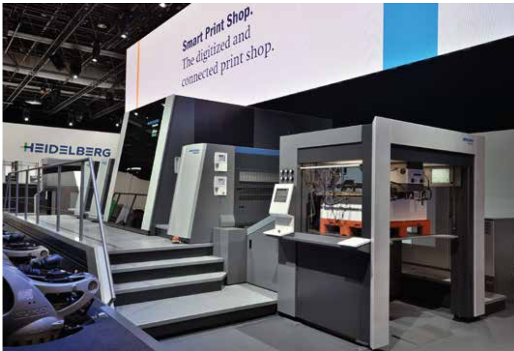
01 Die Heidelberg Primefire 106 ist ein 7-Farben-Inkjetsystem mit Heidelberg Multicolor-Technologie, das rund 95 % des Pantone-Farbraums abdeckt und mit dem man mehr als 12 Mrd. Farbtropfen pro Bogen kontrollieren kann
